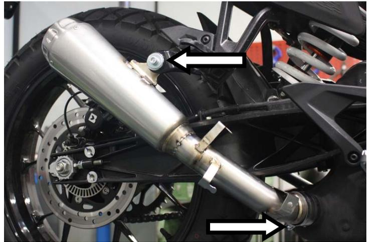
**IT** · Innestare il terminale Pro-Race, fissare l'attacco nel lato interno della staffa e serrare la fascetta
