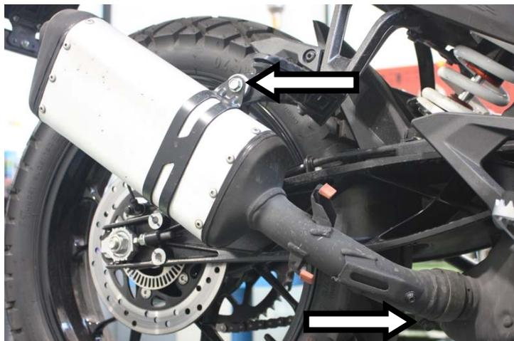
**IT** · Allentare la fascetta, svitare le vite di fissaggio e rimuovere il terminale
