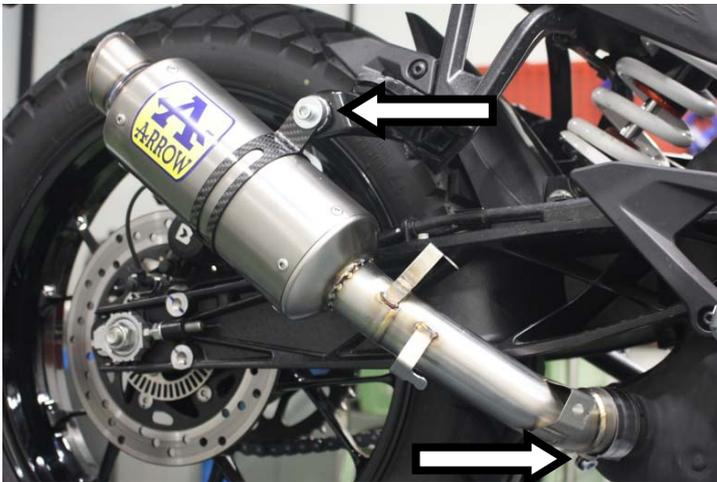
**IT** · Innestare il terminale GP2, fissarlo mediante fascetta di sostegno nel lato esterno della staffa e serrare la fascetta
